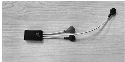
図 2 株式会社スポーツセンシング DSP ワイヤレス筋電センサ
