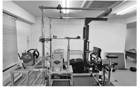
図 1 新たに開発された多用途筋力計
