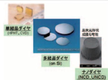
応用例 半導体デバイスのダイヤモンドヒートシンク、耐摩耗コーティング、電気化学用ダイヤモンド電極、弾性表面波デバイス、光学応用 など
