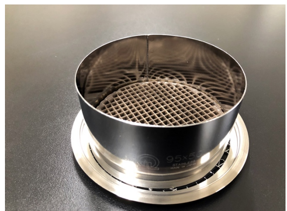
高さ 5 cm のホルダに入れた触媒 (煙突を使わずスペース効率を改善)
