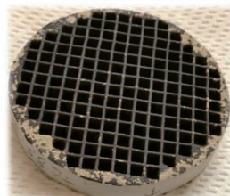
30セル/平方インチ 直径 70 mm 厚さ 10 mm
