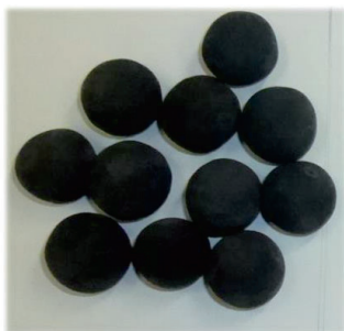
開発した球状PAR: 直径20mm
