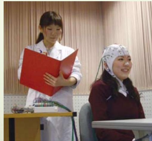
電極キャップを装着して多チャンネルの脳波を計測している様子
