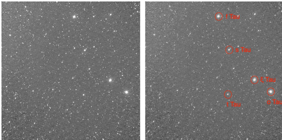
図3 「はやぶさ2」が観測した画像の例(2022年8月29日、おうし座の方向)。ONC-Tの視野サイズ(画角)は一辺6.27度と広く、この広い視野が空に大きく広がった黄道光の観測に適している。このような観測された画像から、検出された星をマスクし、何も映っていない領域の明るさを導出することで黄道光を求めている。右図は明るい星を同定したもので、Tau はおうし座を表す。
